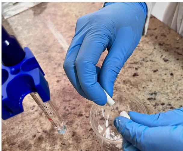
Aferição de pH de matéria-prima antes da liberação para produção.
