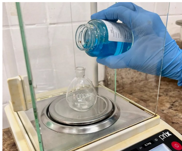
Pesagem de amostra em balança analítica de precisão.
